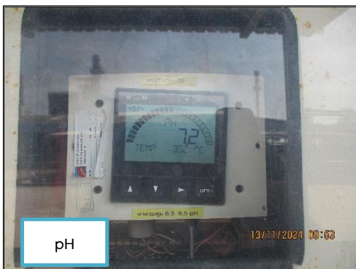
ภาพที่ 2.5 เครื่องตรวจวัดคุณภาพน้ำอัตโนมัติ
